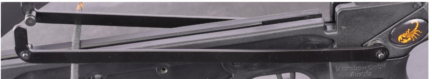
**4** Die Seitenverkleidung kann nun wieder montiert werden. Achten Sie darauf, dass die Stege der Seitenverkleidungen jeweils in den Führungsrollen der beiden Spannarme liegen (4).
